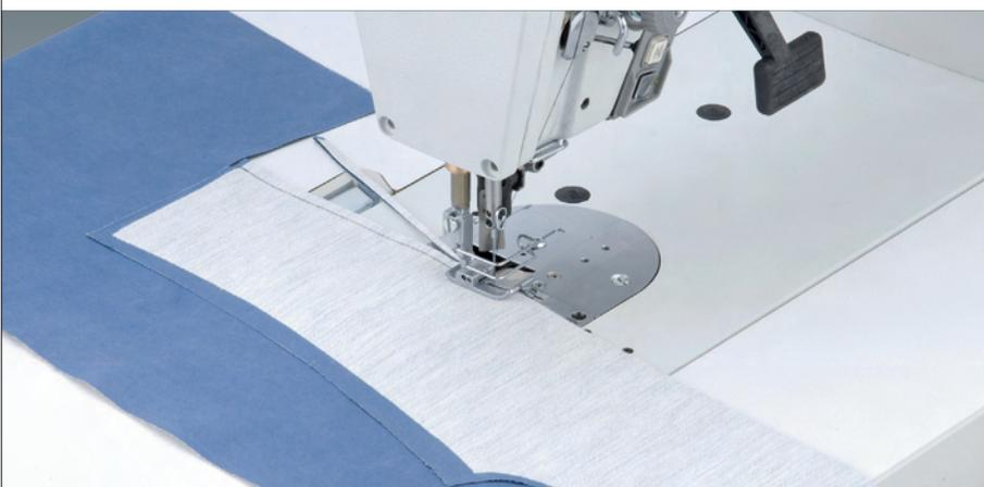
**272-640642-01 mit Nadeltransport und Kantenschneider** ermöglicht verschiebungsfreie glatte Nähte mit sauber abgeschnittenen Nahtkanten.
