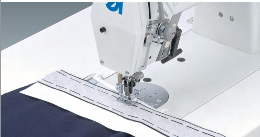
**272-640642-01 mit Nadeltransport und Kantenschneider** z. B. zum Aufnähen von Hosenbunden und gleichzeitigem Beschneiden der Nahtkante
