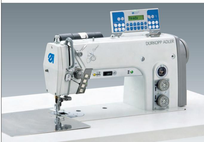
**272-740642-01 – mit elektromotorisch angetriebenen, zuschaltbarem Kantenschneider**
