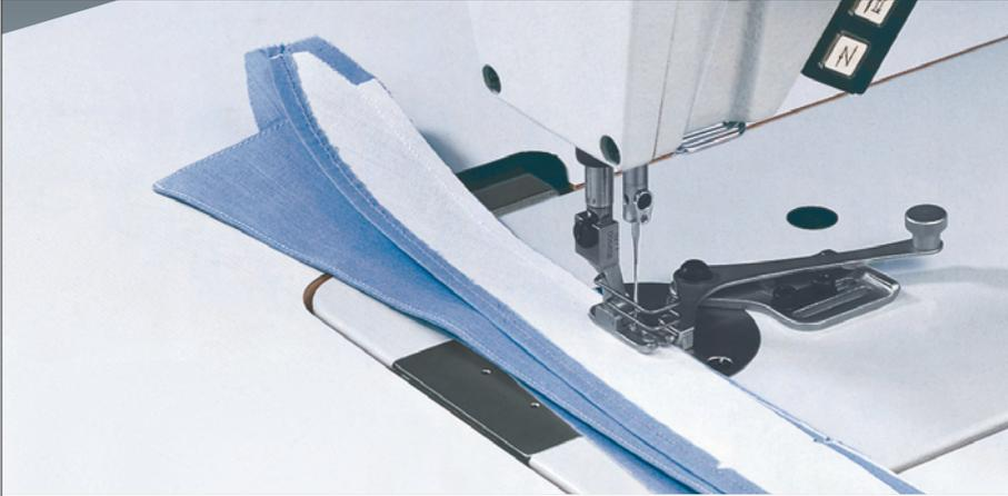
**272-140342-01 – verschiebungsfreie Nähte** durch Nadeltransport – auch in transportkritischen Materialien.
