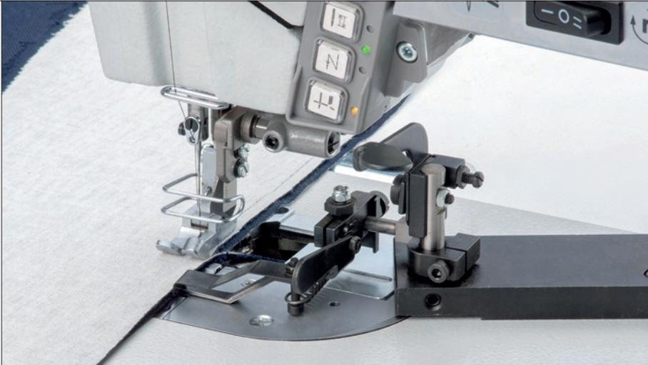
**272-740642-01 mit Nadeltransport und Kantenschneider**
